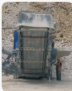
Fot. 6. Pracownik obsługujący kruszarkę – przy pulpicie sterowniczym Photo 6. An employee handling a crusher – at control desk
