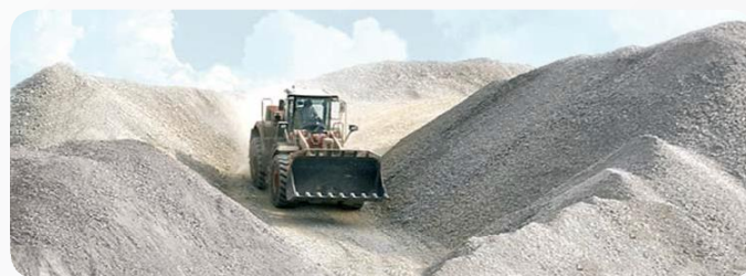
Fot. 4. Naturalny ekran akustyczny w postaci nasypów żwirowych Photo 4. Natural acoustic screening formed from gravel banks
