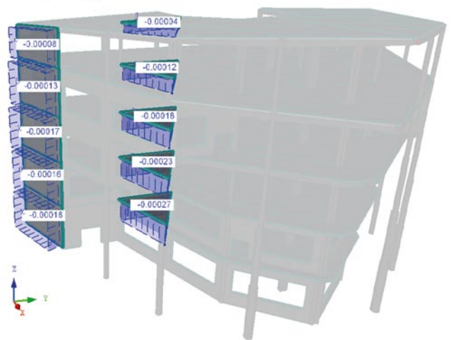
Rys. 14. Wartości odkształceń skurczowych \epsilon w zależności od kondygnacji
