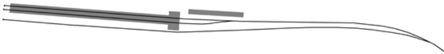
Rys. 5. Układ torowiska dla obiektów związanych z obsługą pociągów sanitarnych na terenie Warsztatów Kolejowych
