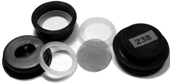
Rys. 1. Próbniki pasywne (PN-98 Z-04092/08)
