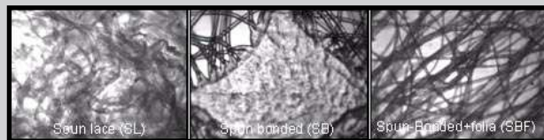
RYS.1. Mikrostruktura włókninowych obłożeń chirurgicznych [6].
