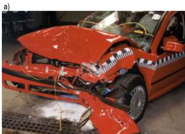
Rys. 6. Uszkodzenia powstałe po zderzeniu pojazdu nowego oraz po naprawie. a) samochód po pierwszym Crash-teście, b) samochód po naprawie i po drugim Crash-teście [8]
