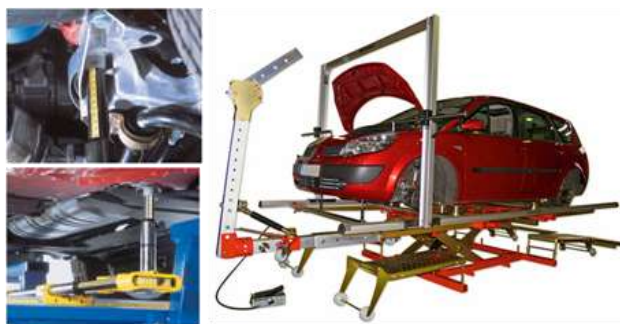
Rys. 5. Mechaniczne urządzenie pomiarowe Autorobot w procesie naprawy karoserii z widoczną wieżą naciagową sterowaną hydraulicznie wraz z różnymi końcówkami pomiarowymi zapewniającymi wymaganą dokładność pomiaru.
