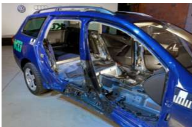
Rys. 8a. Naprawa w pojeździe wykonana nieprawidłowo: w obszarze słupka wstawiono wzmocnienie z blachy zwykłej jakości; prace na ramie naprawczej; oddzielenie słupka na wysokości ok. 40 cm nad dolną krawędzią progu; spawanie MAG; zgrzewanie punktowe oporowe; po wyprostowaniu odkształceń spawanie pęknięć; prąd zgrzewania 6400 A; wyrównanie spoin; powłoka ochronna od spodu; lakierowanie (drzwi, błotnik, bok ramy); montaż i regulacja drzwi; perfekcyjny wygląd [2]
