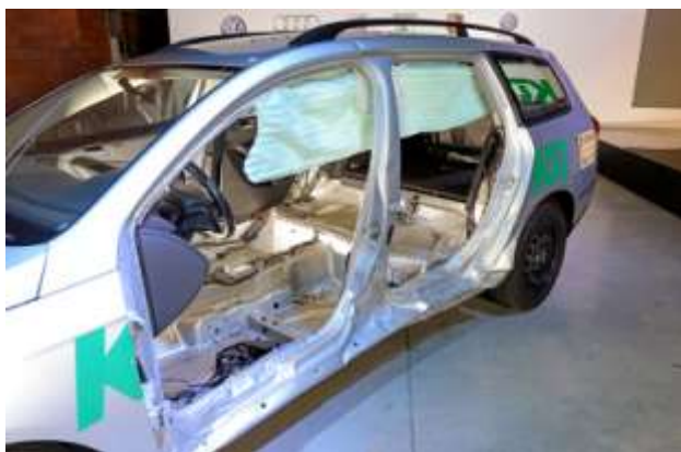
Rys. 7a. Naprawa w pojeździe wykonana prawidłowo: w obszarze słupka środkowe wzmocnienie wykonane z blachy o najwyższej wytrzymałości wymieniono w całości (od dachu do progu i podłogi); prace na ramie naprawczej; wymiana całego słupka; wymiana wszystkich uszkodzonych elementów nadwozia wykonanych ze stali wysokowytrzymałej; spawanie MAG; zgrzewanie oporowe; prąd 10 000 A; regulowany nacisk kleszczy; wyrównanie spoin; powłoka ochronna od spodu; lakierowanie (drzwi, błotnik, bok ramy); montaż i regulacja drzwi; perfekcyjny wygląd [2]
