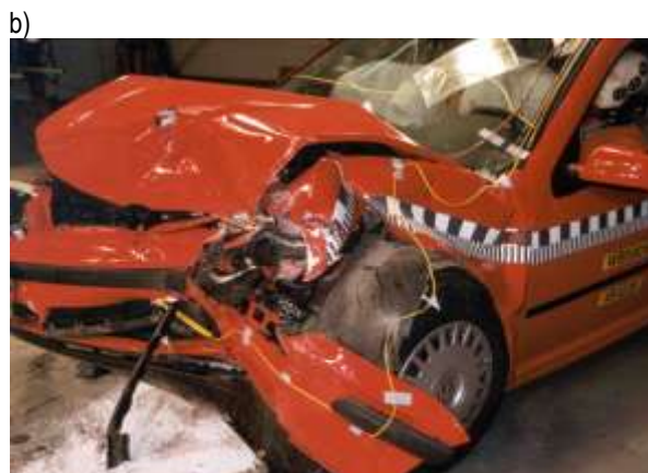
Rys. 6. Uszkodzenia powstałe po zderzeniu pojazdu nowego oraz po naprawie. a) samochód po pierwszym Crash-teście, b) samochód po naprawie i po drugim Crash-teście [8]
