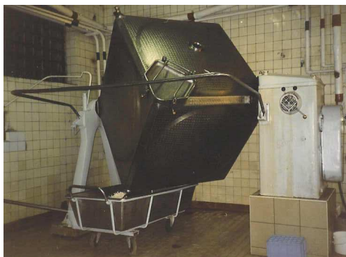
Rys. 1 Masielnice zbiornikowe: a) drewniana, b) metalowa
