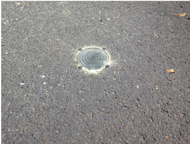
Rys. 1. Czujnik ultradźwiękowy zamocowany na jednym z miejsc parkingowych w Gliwicach
