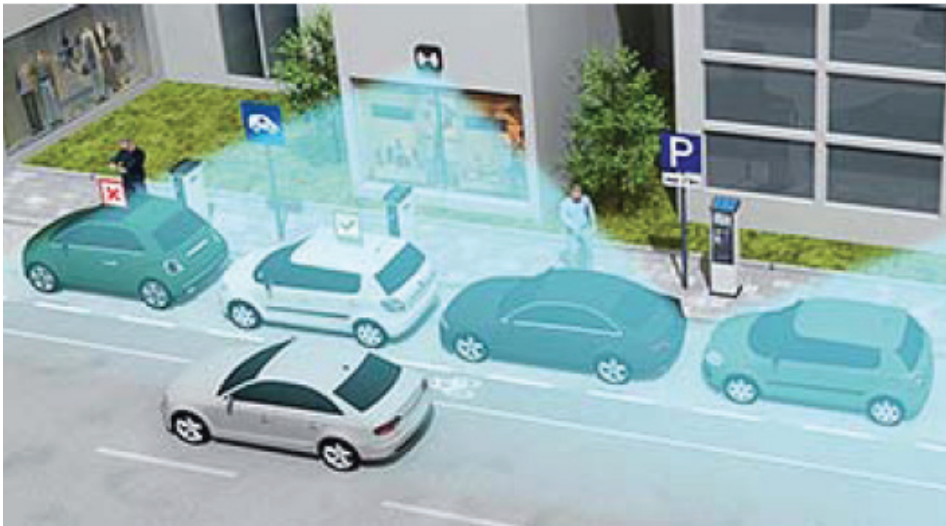
Rys. 2. Czujnik radarowy zamocowany nad miejscami parkingowymi [18].
