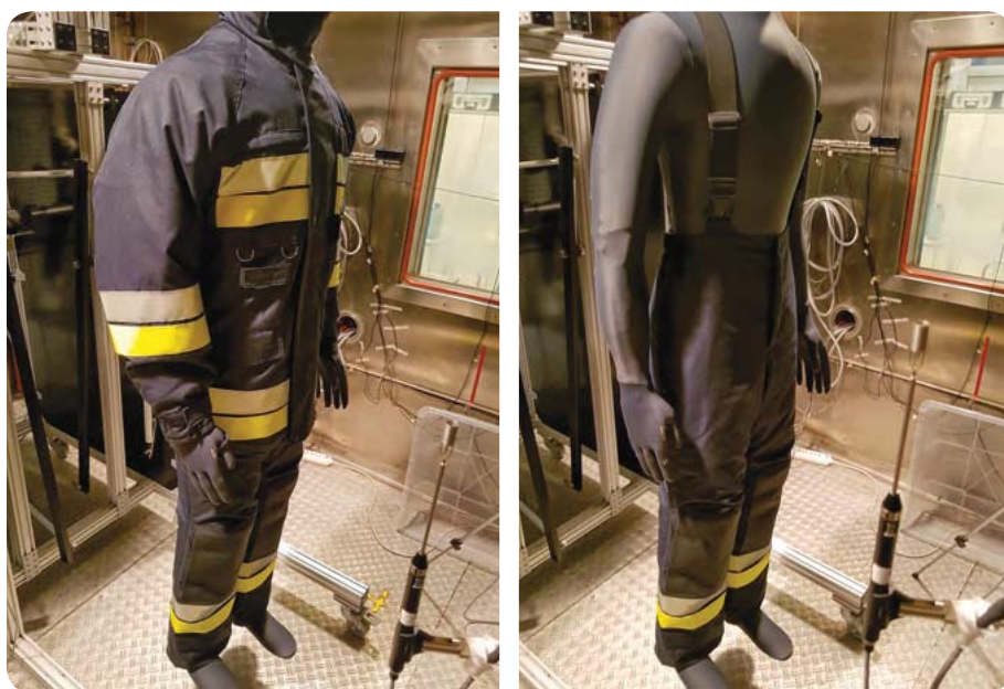
Fot. Ubranie specjalne SX-03 na manekinie termicznym Newton ( fot. autorki) Photo. The special clothing (SX-03) on the thermal manikin (Newton)
