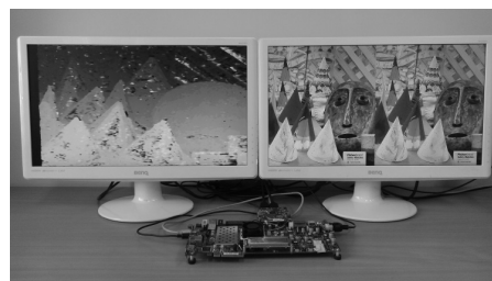
Rys. 3. Działający system. Lewy ekran: mapa dysparycji, prawy ekran obraz testowy w trybie side by side . Rozdzielczość 1280 x 720 @ 60 fps Fig. 3. The working system. Left screen: disparity map, right screen test image in side by side mode. Resolution 1280 x 720 @ 60 fps
