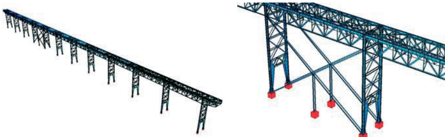
Rys. 4. Wizualizacja schematu obliczeniowego konstrukcji M1 (cała estakada)
