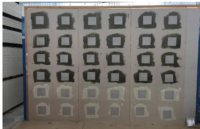
Rys. 1. Płytki gresowe zamocowane do powierzchni badawczej z płyt gipsowo-kartonowych
