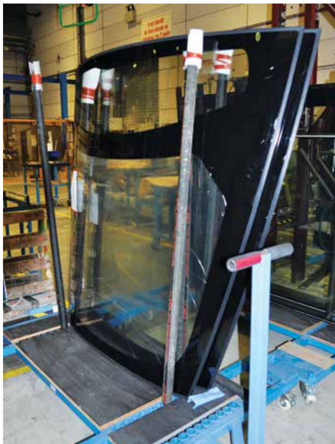
Wypukła szyba przygotowana do montażu jako szyba czołowa na terenie zakładu AGC w Seneffe (4.09.2017 r.)
