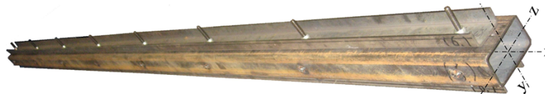
Rys. 8. Badany pręt złożony – przed instalacją łączników BOM
