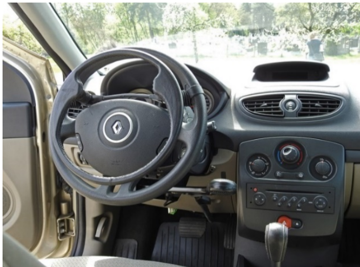
Fot. 2. Urządzenie do ręcznej obsługi gazu i hamulca (Źródło – ITS)
