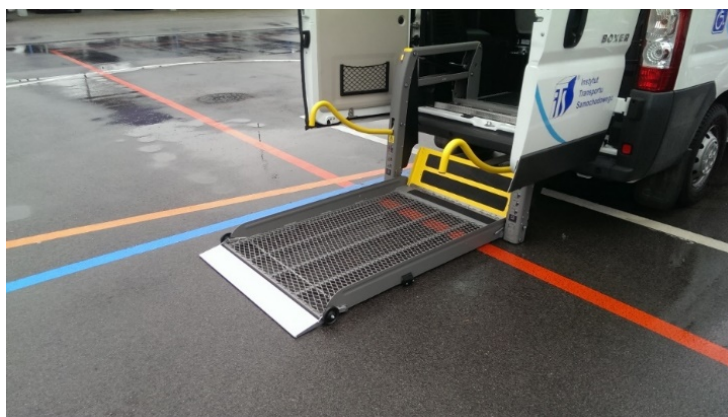
Fot. 1. Podest do przemieszczania osoby z niepełnosprawnością (Źródło – ITS) Fot. 1. Platform for moving people with disabilities (Source - ITS)
