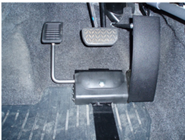
Fot. 3. Przeniesienie pedału gazu na lewą stronę (Źródło – ITS)
