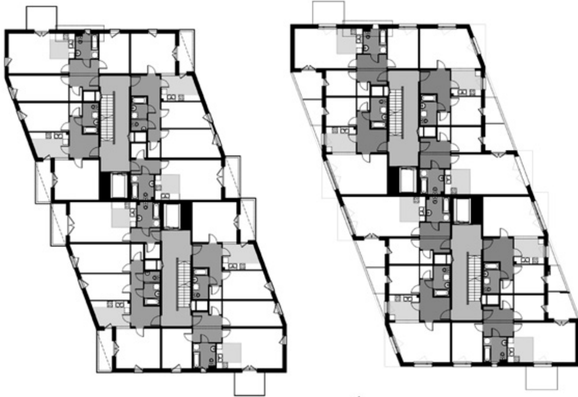
il. 2. Budynki dwuklatkowe, osiedle Sławka w Katowicach, a – rzut 1. piętra, b – rzut 3. piętra, c – widok / Double-staircase buildings, Sławka Housing Estate in Katowice, a – first floor, b – third floor, c – view
