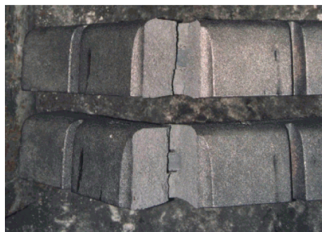
Rys. 6. Wykonane z zastosowaniem oprzyrządowania testowego wersji IV odlewy wstawek DO-380B. Po próbie kafarowej przełomy odlewów były bez wad
