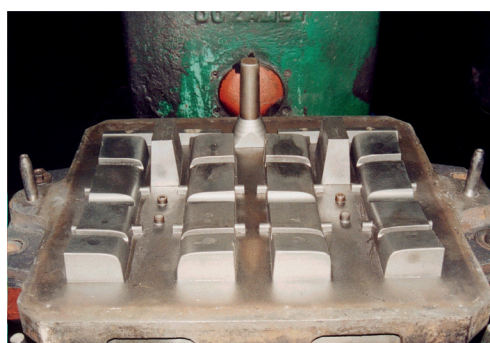
Rys. 2. Płyta modelowa górna i dolna wstawki hamulcowej DO-320B. Czwarta wersja z nadlewami bocznymi
