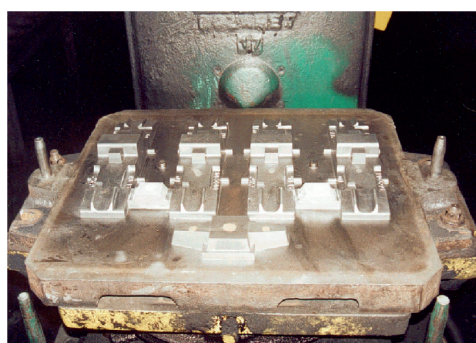
Rys. 2. Płyta modelowa górna i dolna wstawki hamulcowej DO-320B. Czwarta wersja z nadlewami bocznymi
