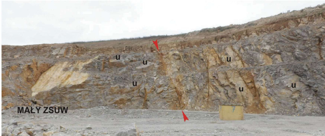
Fot. 2. W środku ściany gwałtowna zmiana nachylenia warstw wzdłuż rdzawej pionowej dyslokacji 165/85W (czerwone strzałki). Na zachód od dyslokacji (w prawo za schronem 7) nieco skrasowiałe, rdzawe powierzchnie warstwowania o upadach do 70°. Tuż na wschód od dyslokacji nachylenie spada skokowo do 095/46N, a całkiem na wschód znajduje się mały zsuw 095/43N (Cała i in. 2017b)
