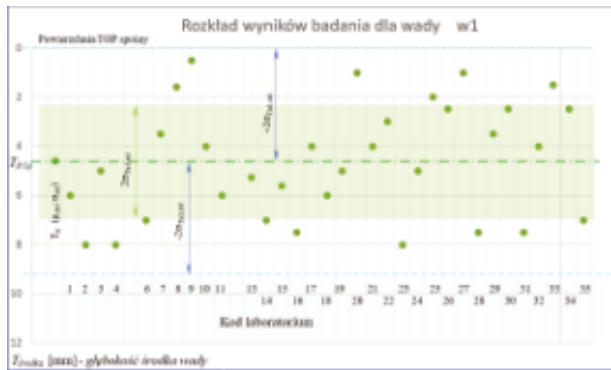
Rys. 7. Rozkład wyników badania ultradźwiękowego dla wady „w1” (zielone punkty), uzyskanych przez laboratoria na tle średnich statystycznych parametrów \mu_{std} oraz \sigma_{std} dla tej wady: głębokość środka wady względem powierzchni TOP spoiny – T_{sr1} = \mu_{T_{sr1}, std} \pm \sigma_{T_{sr1}, std} w [mm] - (linia przerywana – kolor zielony). Naniesiono również pasy odchylenia standardowego (kolor jasnozielony). Liniami niebieskimi (przerwanymi) podano także położenia dla podwójnego odchylenia standardowego T_{sr1, \mu} = \mu_{T_{sr1}, std} \pm 2\sigma_{T_{sr1}, std} w [mm].
