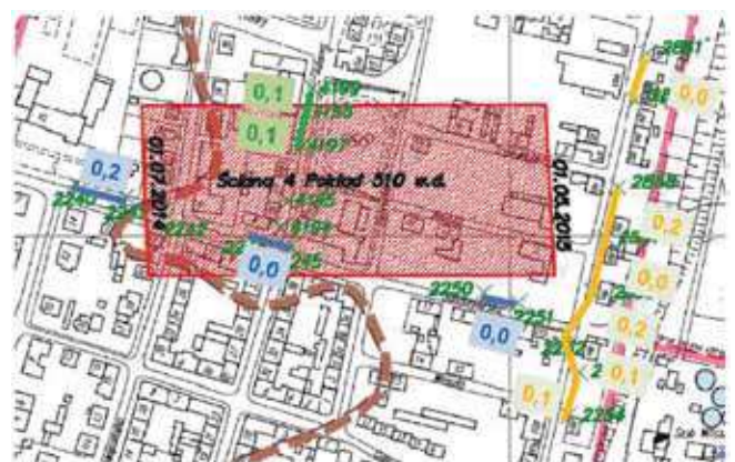
Rys. 13. Mapa z wynikami deformacji w przedmiotowym rejonie Fig. 13. Map presenting the terrain deformation in the relevant area
