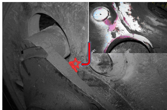
Rys. 6. Charakter obciążenia dynamicznego, miejsce pobrania próbek (oznaczone gwiazdką)
