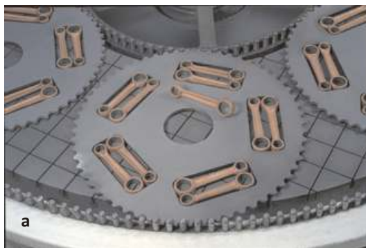
Rys. 1. Widok: a) obiegowego układu kinematycznego docierarki do obróbki powierzchni płasko-równoległych [5], b) docierarki dwutarczowej AC 700-F firmy Peter Wolters (prędkości obrotowe tarcz docierających 160/300 min -1 , prędkość obrotowa kołkowego pierścienia wewnętrznego 83 min -1 ) [7]
