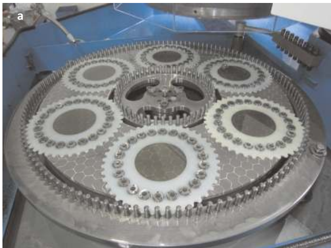
Rys. 5. Widok: a) układu wykonawczego szlifowania z kinematyką docierania dwutarczowego [8], b) docierarki dwutarczowej do szlifowania powierzchni płasko-równoległych (ze stołem załadowniczym i wyladowczym) firmy Stähli [9]
