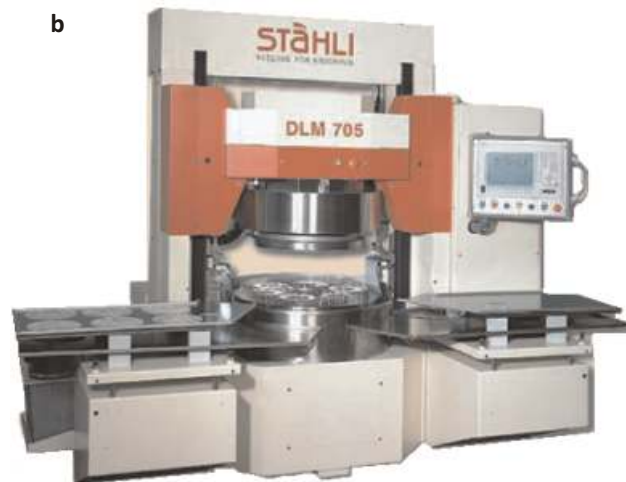
Rys. 5. Widok: a) układu wykonawczego szlifowania z kinematyką docierania dwutarczowego [8], b) docierarki dwutarczowej do szlifowania powierzchni płasko-równoległych (ze stołem załadowniczym i wyladowczym) firmy Stähli [9]
