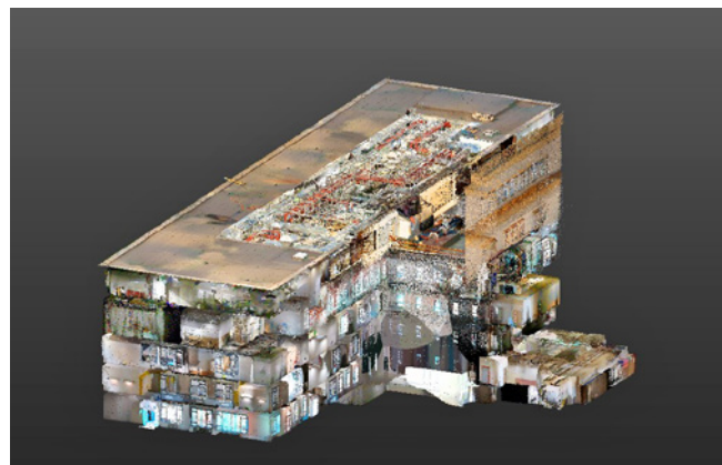
Chmura punktów wykonana przez STRABAG na budowie Szpitala Bielańskiego, oprac. autora
