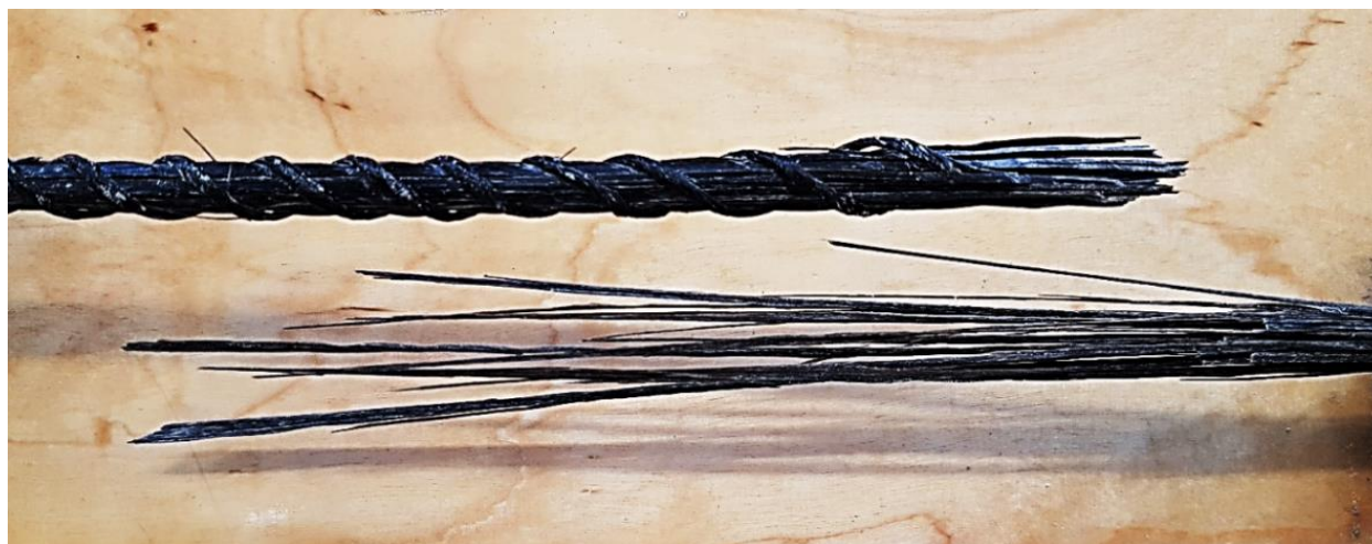
Rys. 8. Widok zerwanego pręta BFRP o średnicy 6 mm
