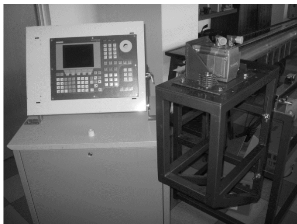
Rys. 5. Układ sterowania i układ napędowy stanowiska pomiarowego Fig. 5. Computer Numerical Control and drive unit
