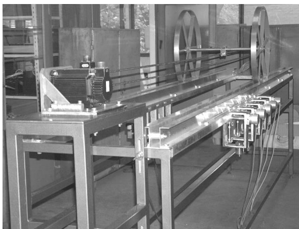
Rys. 4. Model toru z zabudowanymi układami pomiarowymi Fig. 4. Rail of measure stand with assembled measuring units
