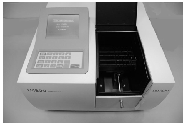
Rys. 1. Spektrofotometr UV-VIS użyty do badań. Fig. 1. Spectrophotometer UV-VIS used for measuring.
