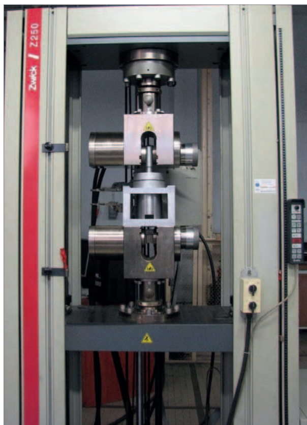
Rys. 3. Widok układu pomiarowego do wyznaczenia współczynnika HE zainstalowanego na trawersie maszyny wytrzymałościowej Zwick Z250
