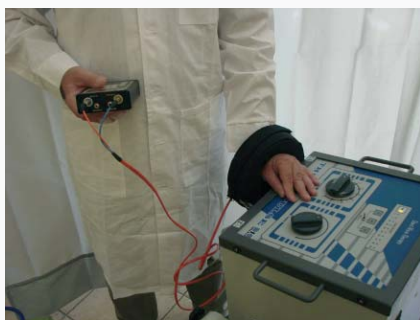
Rys. Z4. Przykład wykorzystania miernika indukcyjnego ( clamp-on ) do pomiaru prądu dłoni na nadgarstku pracownika dotykającego pulpitu generatora diatermii krótkofalowej Fig. Z4. The example of the use of inductive meter ( clamp-on ) for the measurements of the palm current on the wrist of worker who touches the console of short-wave diathermia generator
