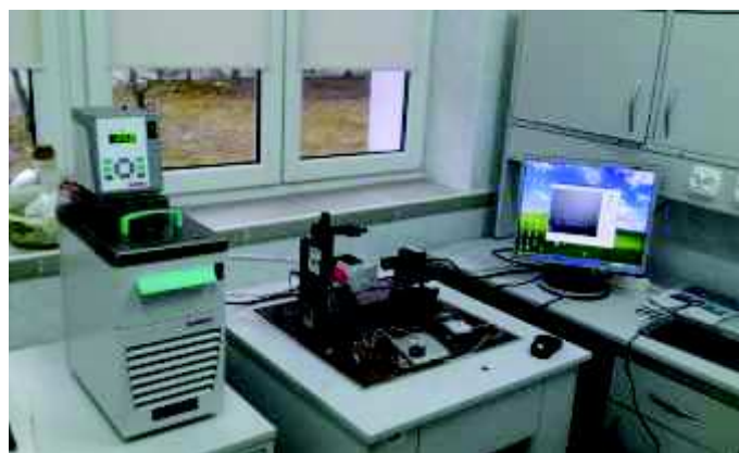
Rys. 2. Urządzenie do pomiaru kąta zwilżania KSV CAM 100 z komorą pomiarową termostatową
