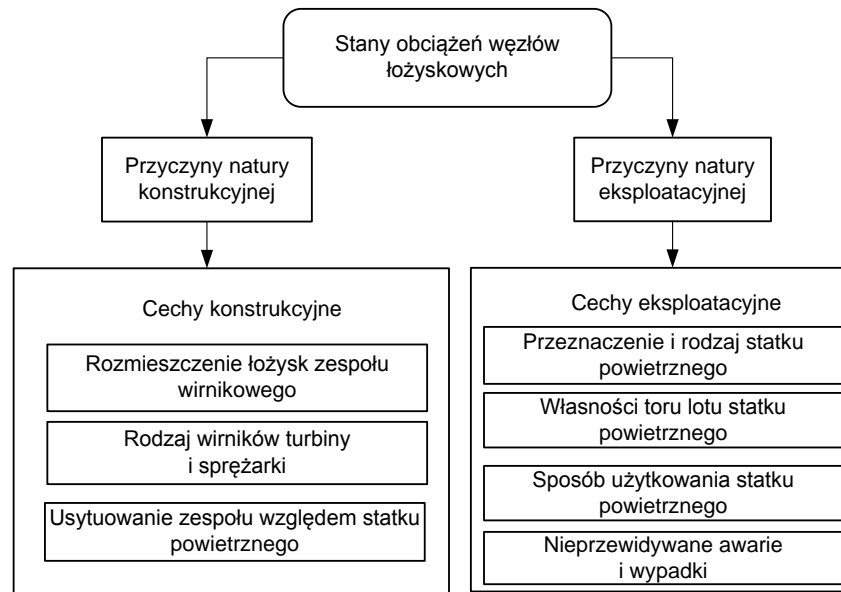
Rys.1. Schemat usystematyzowania przyczyn powstawania obciążeń wytworniczego zespołu wirnikowego silnika turbinowego [7]
