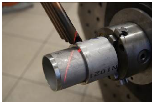
Rys. 1. Widok zrobotyzowanego stanowiska badawczego do spawania laserowego (a) i element testowy zamocowany w obrotniku urządzenia (b)
