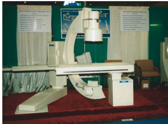
Rys. 1 Wystawa firmy Omega Medical Imaging na konferencji kardiologicznej w Nowym Orleanie (1997) – prezentacja systemu angiograficznego z nowatorskim rozwiązaniem pozycjonera LC („nożycówka”)
