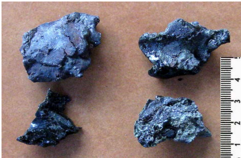
Fot. 14 Żuźle ze współczesnego wytopu rudy hematytowo-magnetytowej. Żuźle górne – z resztkami minerałów żelaza. Żuźle dolne – szkliste.
