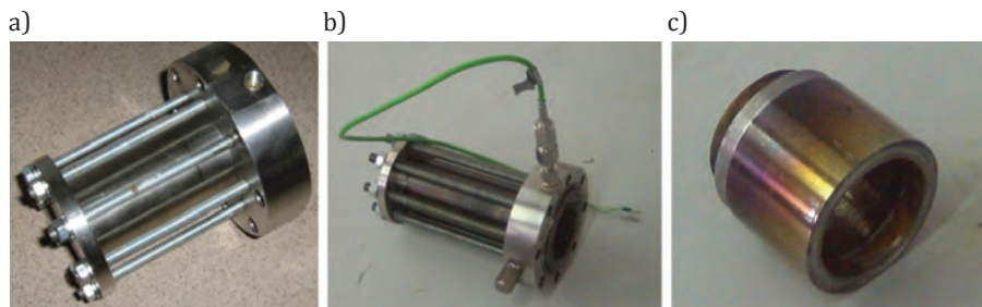
Rys. 2. Różne konfiguracje komór katalitycznych o długościach: a) 100 mm z płaszczem chłodzącym, b) 120 mm, c) 50 mm
