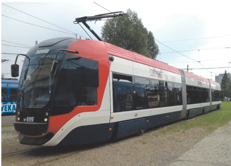
Ryc. 24. Wagon tramwajowy typu 126N „Nevelo” produkcji NEWAG SA.
