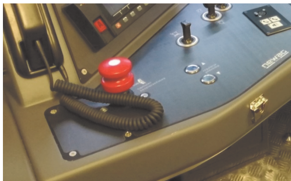
Ryc. 9. Przycisk wdrażania hamowania nagłego (bezpieczeństwa) na pulpicie maszynisty, który bezpośrednio odpowietrza mechanicznie przewód główny.
