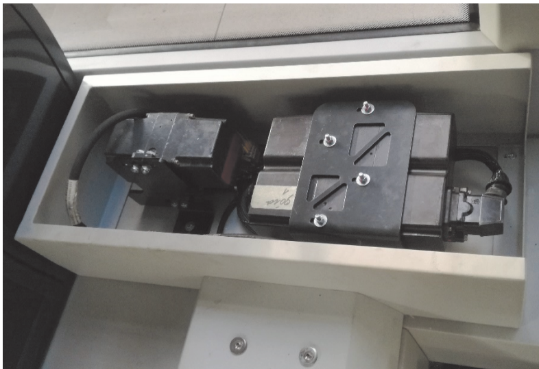
Ryc. 21. Agregaty hamulców pasywnych – po lewej awaryjny, po prawej główny.
