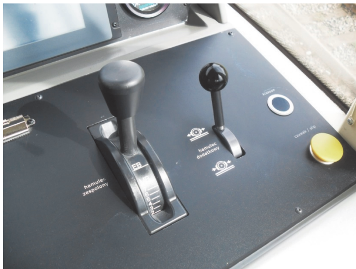
Ryc. 12. Pulpit maszynisty – nastawnik hamulca zespolonego (lewy) i nastawnik hamulca dodatkowego (prawy).
