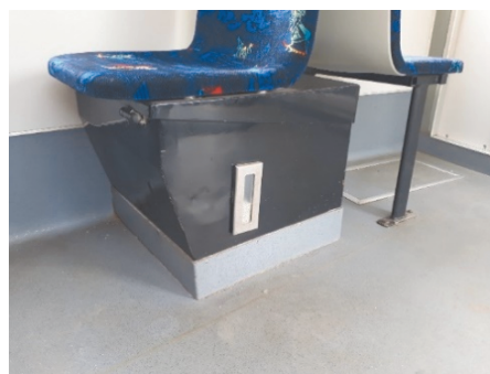
Ryc. 29. Zbiornik piasku w podwoziu pojazdu – po lewej na wózku jezdnym, po prawej pod siedzeniem pasażerskim.
