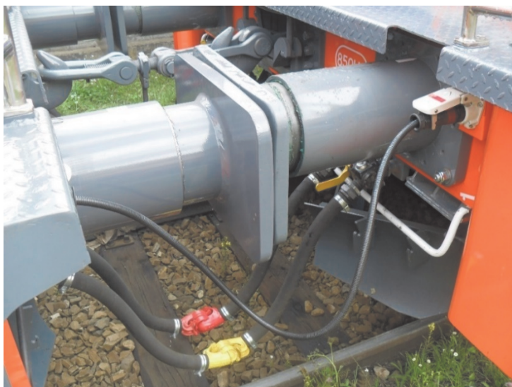
Ryc. 11. Sprzęgi między pojazdami; głowice czerwone – sprzęg przewodu głównego – PG (hamulcowego).
