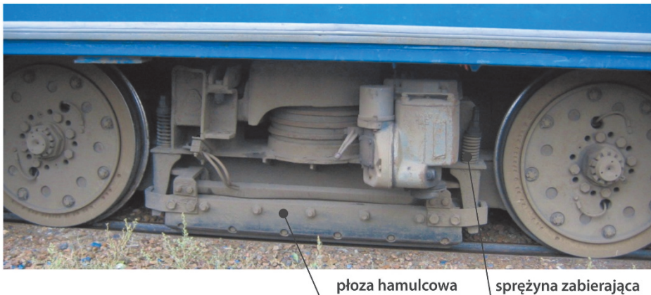
Ryc. 14. Elektromagnetyczny hamulec szynowy w wózku tramwaju.
