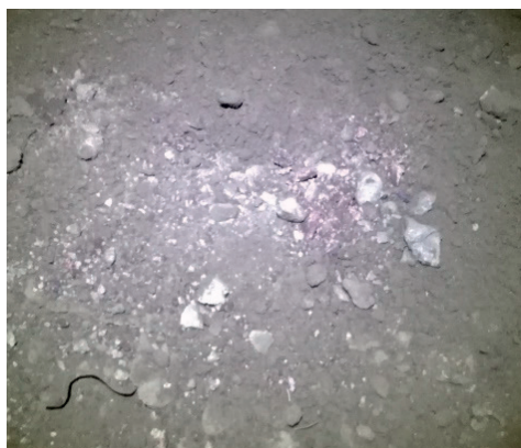
Rys. 5. Pozostałość mieszaniny na podłożu bunkra po gasnącej detonacji mieszaniny zawierającej 50% chloranu(V) sodu i azotan(V) amonu granulowany
