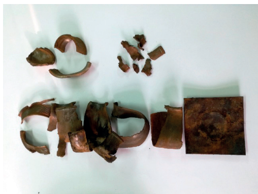
Rys. 13. Zebrane fragmenty rury stalowej
