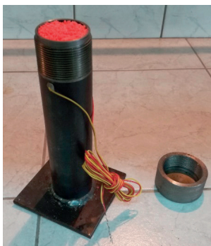
Rys. 11. Układ gotowy do próby przejścia deflagracji w detonację
