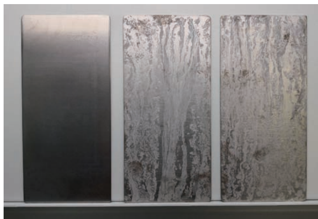
Rys. 3. Płytki kalibracyjne stalowe CR4 przed i po badaniu (wytrawione) po czasie 48h [opracowanie własne]
