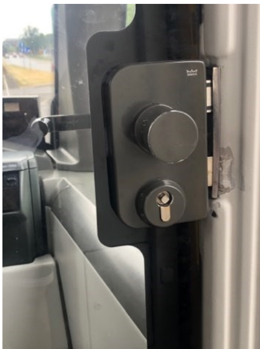
Rys. 3. Zamek otwierania drzwi kabiny motorniczego
