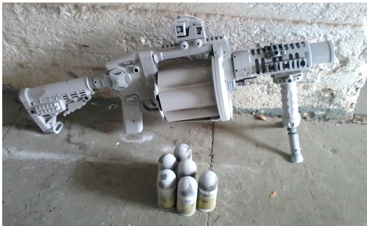
Fot.1. Badany granatnik po dynamicznym oddziaływaniu pyłu i piasku Photograph 1. Tested grenade launcher after dynamic impact of dust and sand
