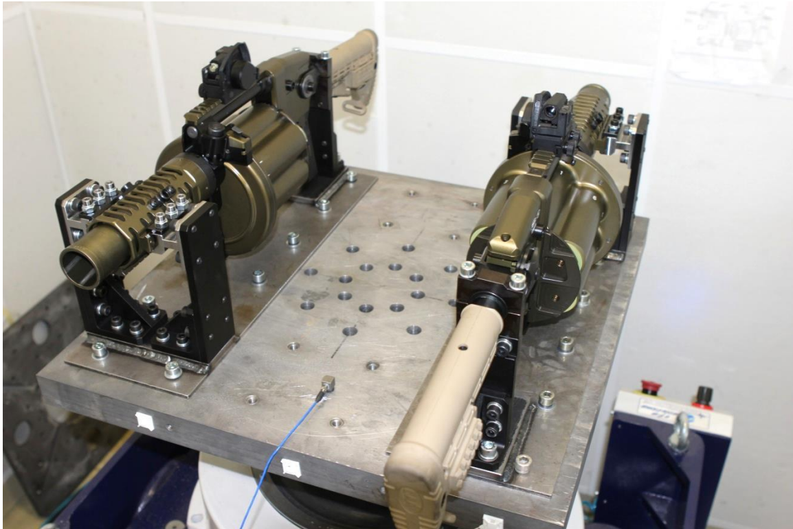
Fot. 2. Badane granatniki na stole systemu wibracyjnego Photograph 2. Tested grenade launchers on the vibrating table
