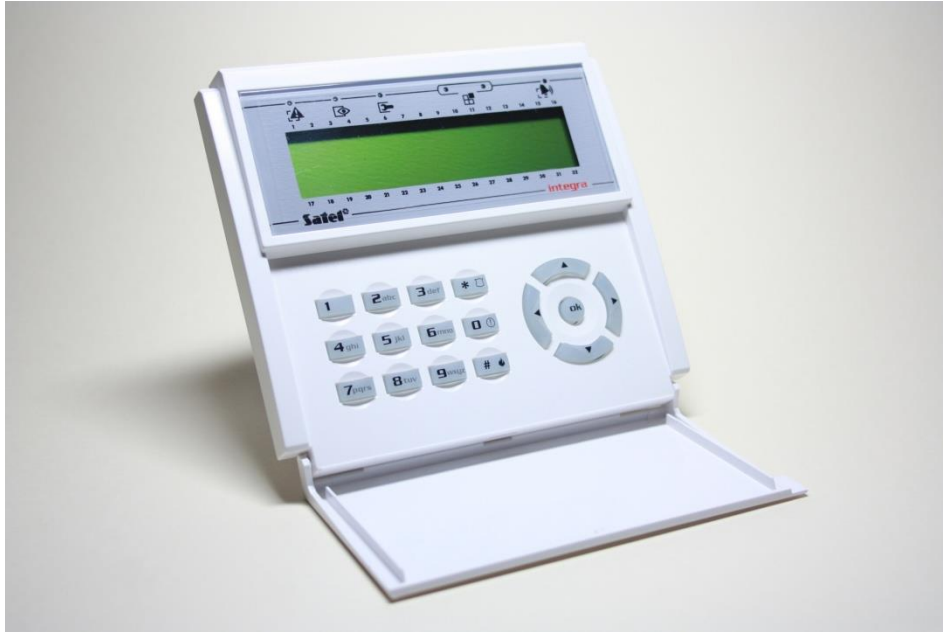
Rys. 1. Przedstawiciel jednych z najbardziej podstawowych interfejsów człowiek – system wykorzystywanych w systemach SWiN na przykładzie manipulatora INT-KLCD [3]
