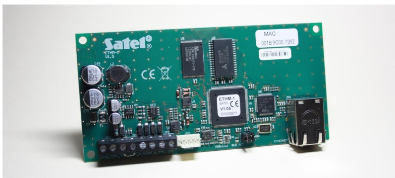
Rys. 4. Interfejs fizyczny dedykowany do komunikacji między urządzeniami na przykładzie modułu ETHM-1 [3]
