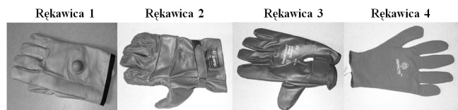
Rys. 1. Rękawice antywibracyjne wybrane do badań Fig. 1. Anti-vibration gloves selected for tests
