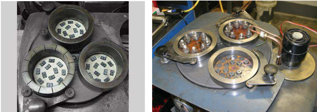
Rys. 1. Docierarki jednotarczowe [16] Fig. 1. Single-disk lapping machines [16]
