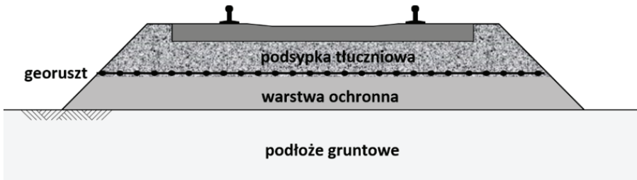
Rys. 8. Zastosowanie georusztu do stabilizacji podsypki tłuczniowej
