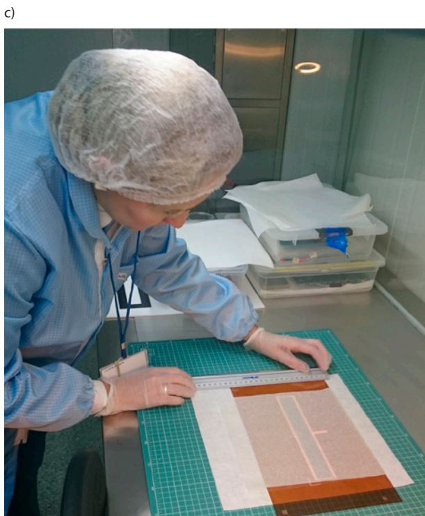
Fot. 2. (a) Folia GEM o powierzchni aktywnej 200x20 mm 2 naklejona na ramkę wykonaną ze szkła epoksydowego, (b) folia GEM o powierzchni aktywnej 100x100 mm 2 przygotowana do klejenia na ramkę, (c) prace montażowe w tzw. czystym pomieszczeniu
