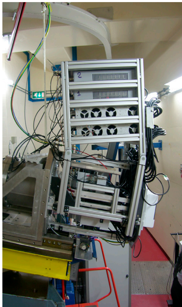
Fot. 6. Zdjęcie systemu pomiarowego składającego się z dwóch detektorów GEM dla dwóch kanałów pomiarowych spektrometru KX1 na tokamaku JET
