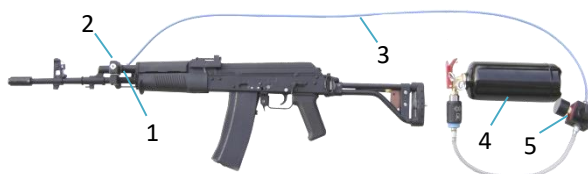
Fot. 4. Układ elektro-pneumatyczny wymuszania ruchu mechanizmów w 5.56 mm kbs BERYL: 1 – siłownik, 2 – elektro-zawór, 3 – przewody gazowe, 4 - butla, 5 – reduktor
