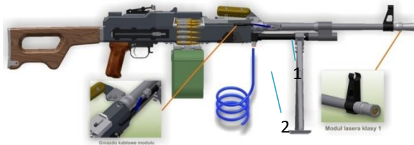
Fot. 8. Układ mechaniczno-pneumatyczny wymuszania ruchu mechanizmów 7.62 mm UKM2000P: 1 – siłownik, 2 – przewody gazowe
