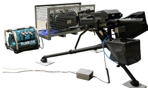
Fot. 13. Symulator 40 mm granatnika automatycznego MK-19
