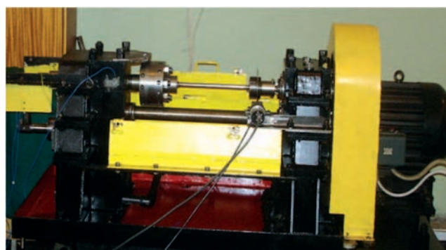
Rysunek 1 Widok stanowiska mocy zamkniętej
