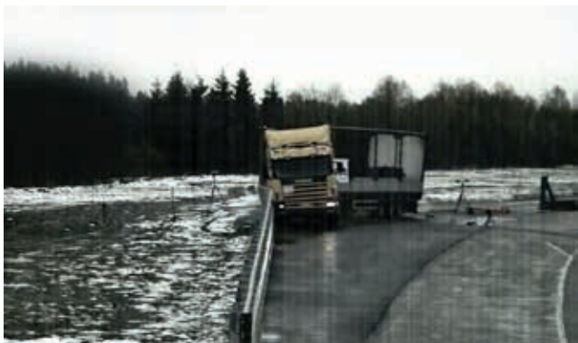
Test zderzeniowy dla klasy H4b nowej bariery drogowej Saferoad, fot. Saferoad
