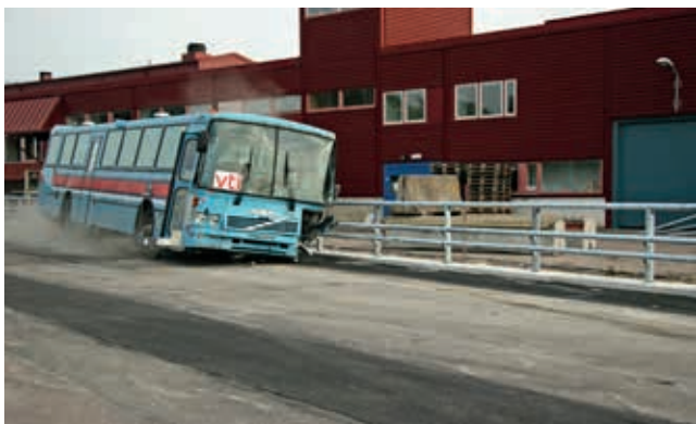
Test zderzeniowy bariery mostowej Saferoad, Szwecja, fot. Saferoad
