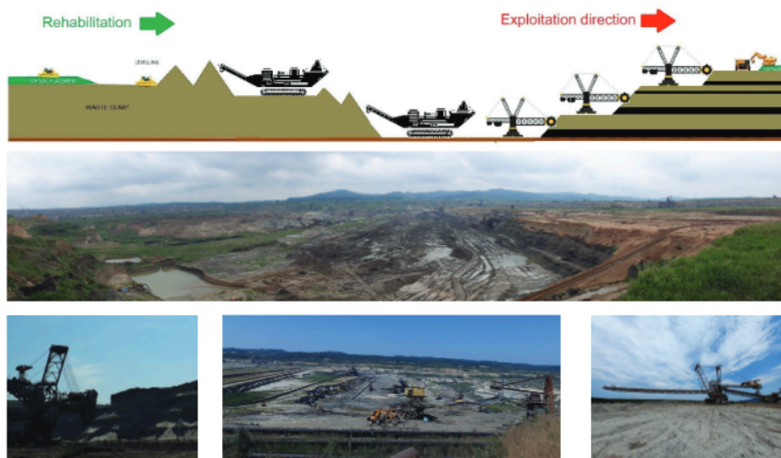
Fig. 9. Scheme for the rehabilitation of degraded land simultaneously with the continuation of exploitation (Feng et al., 2019) Rys. 9. Schemat rekultywacji terenów zdegradowanych przy jednoczesnej kontynuacji eksploatacji (Feng et al., 2019)
