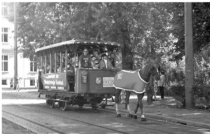
Fot. 24. Wrocław 2006 – replika tramwaju konnego, odkrytego, na oryginalnym podwoziu
