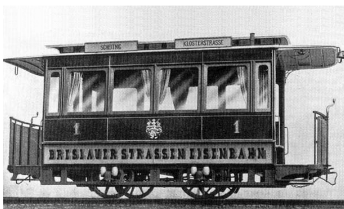
Fot. 22. Wrocław 1877–1890 – przyczepka tramwaju konnego zastosowana w tramwaju elektrycznym
