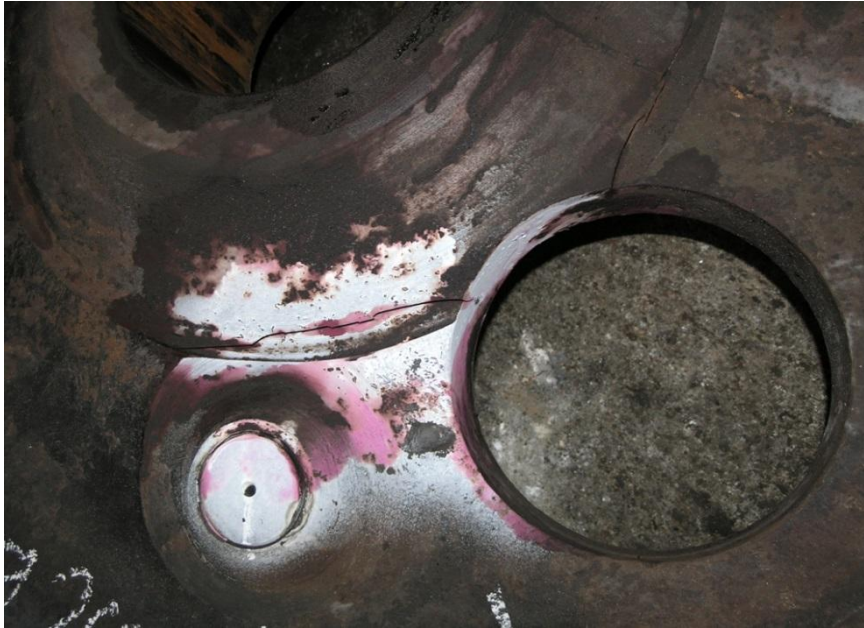
Rys.1. Pęknięcie koła napędowego lokomotywy EU07 wykryte metodą penetracyjną barwną Fig.1. Crack of the drive wheel of the EU07 locomotive detected with penetrative colorfull method
