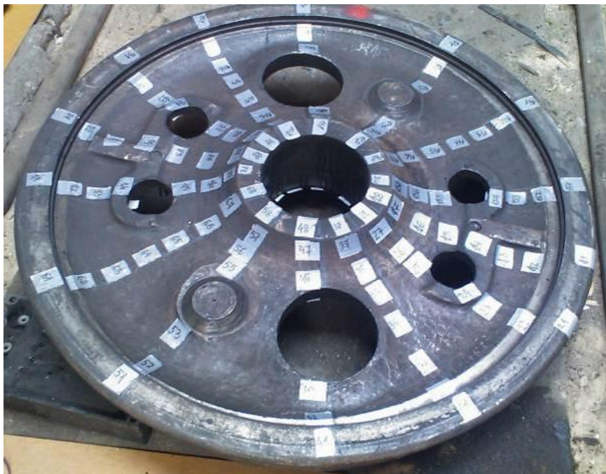
Rys.4. Koło napędne lokomotywy EU07, z zaznaczonymi miejscami pomiarów Fig.4. Driving wheel of EU07 locomotives with marked places of measurements
